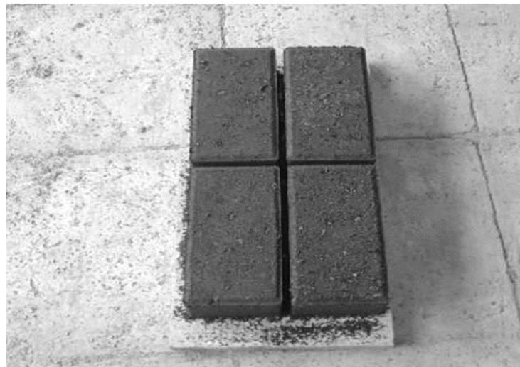
**3.6 Adoquines con 35% de polvo de llanta****Tabla 3***Proporcionamiento mezcla A-2 con un 35% de polvo de llanta.*
