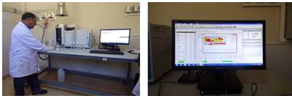
Figura 7: Ejecutando el análisis con el sistema de Espectroscopía de Absorción Atómica.
