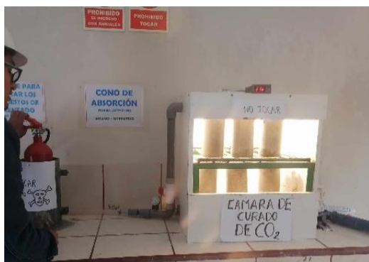
Figura 5. Curado de concreto con dióxido de carbono.
