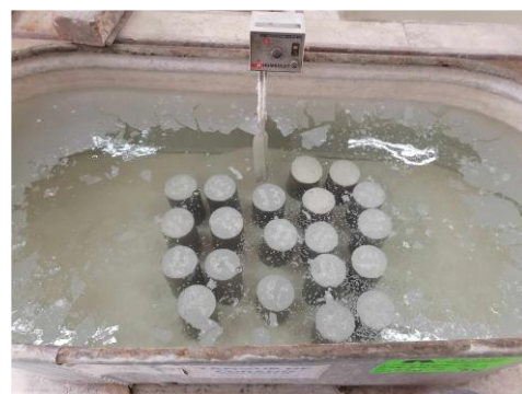
Figura 4. Curado de probetas con agua en tanque temperado.
