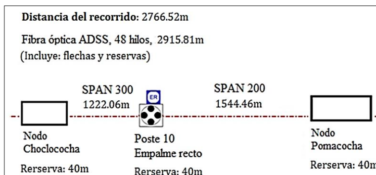
Fig. 6. Diagrama unifilar de la red de transporte
