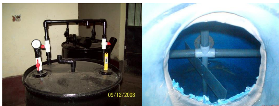
Figura 1.- Instrumentos instalados en el prototipo de biodigestor a fin de controlar los parámetros de presión y temperatura
